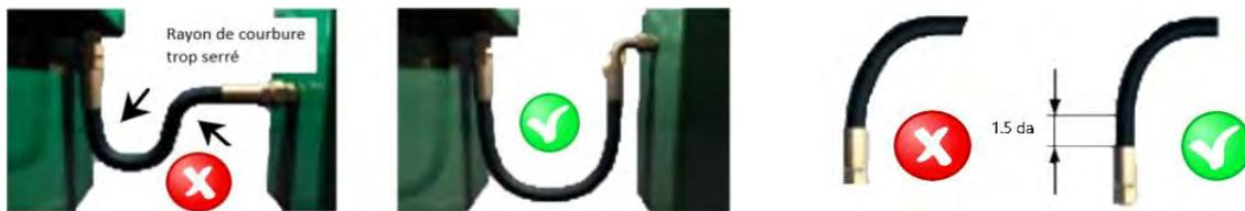
Les embouts doivent avoir 1.5 X le diamètre extérieur du boyau avant la flexion, sinon un dispositif de protection contre les plis devrait être installé.
