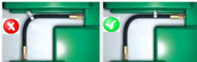
Les supports à boyaux doivent être installés sur la section droite du boyau. Dans le cas contraire, le boyau risque de s'endommager par le support lui-même.
