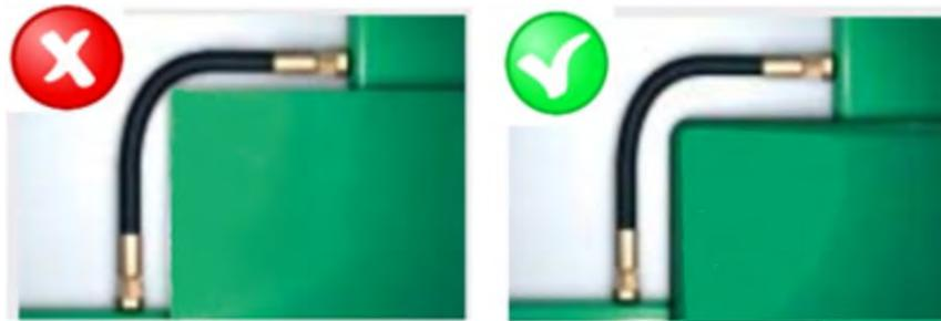
Le boyau ne doit pas être en contact avec le rebord d'un équipement. Le même principe s'applique pour des boyaux qui se frottent entre eux. Dans l'éventualité qu'un frottement est inévitable, il existe des boyaux avec un revêtement ultra solide, voir la série "PRO" de Hansa Flex.
