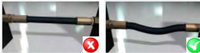
Pour les boyaux court, il faut laisser un "lousse" entre les deux connections, pour permettre l'amortissement des coups de bélier. Un coup de bélier peut être considéré simplement en actionnant la pression dans le circuit hydraulique.
